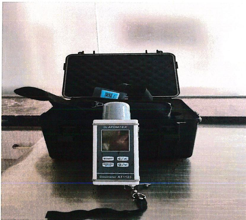
图 6-2 x- $\gamma$  剂量率仪
