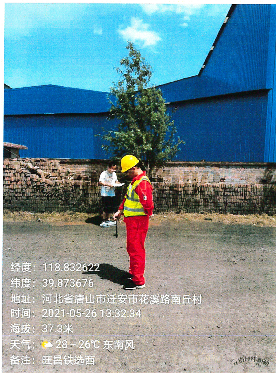
图 6-3 上半年现场 \gamma 辐射剂量率监测
