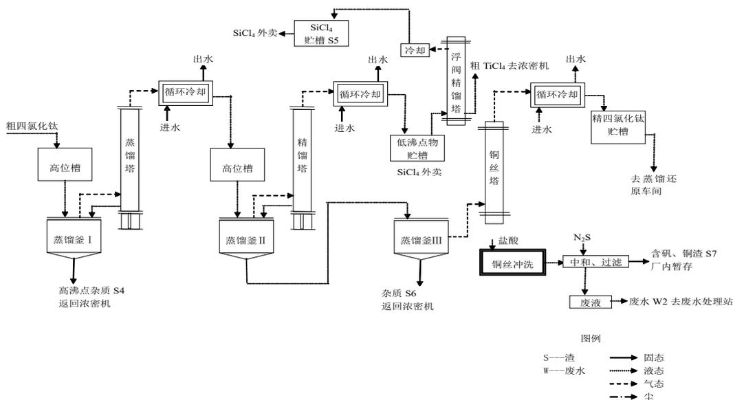
图 2-2 精制车间生产工艺及排污节点图
