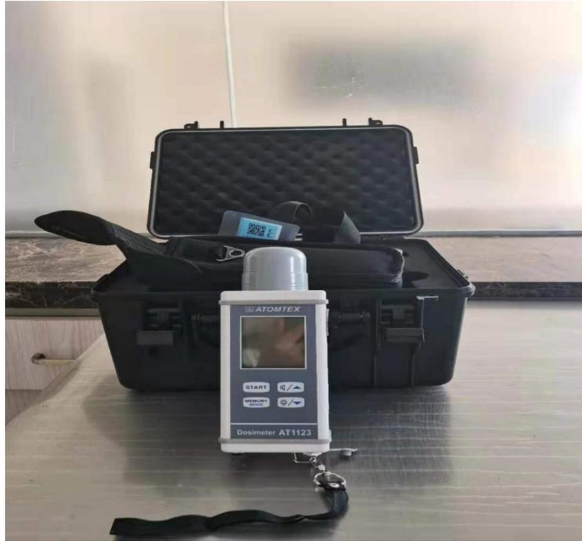
图 6-2  $\chi$ - $\gamma$ 剂量率仪
