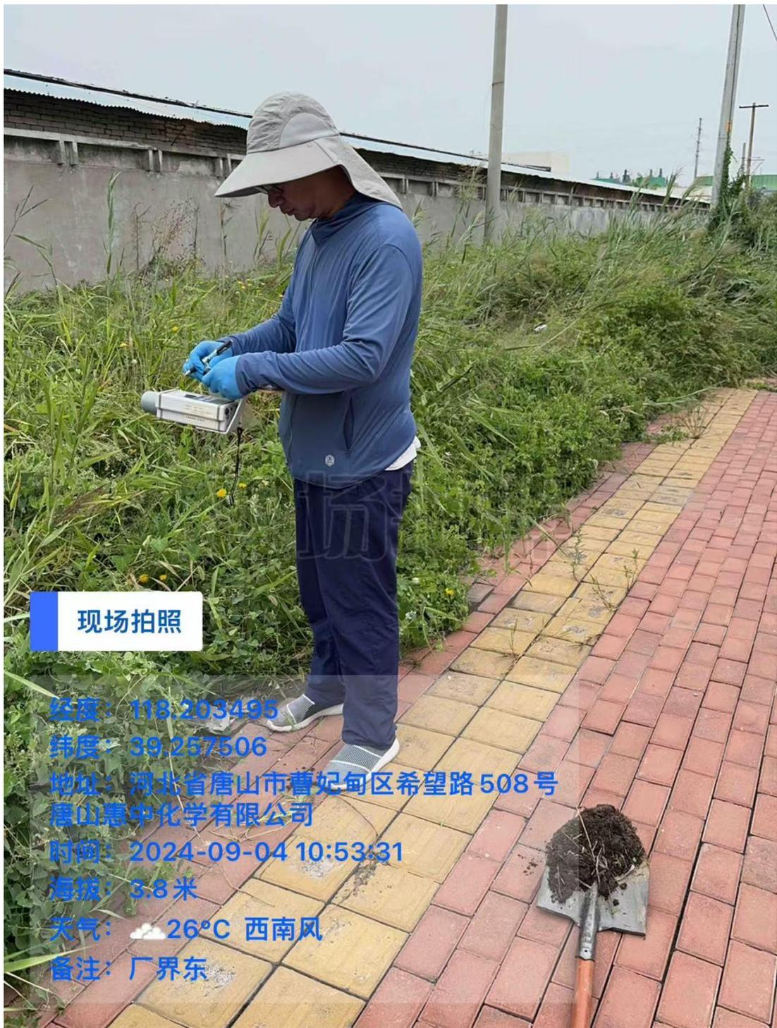
图 6-3 现场 $\gamma$ 辐射剂量率监测
