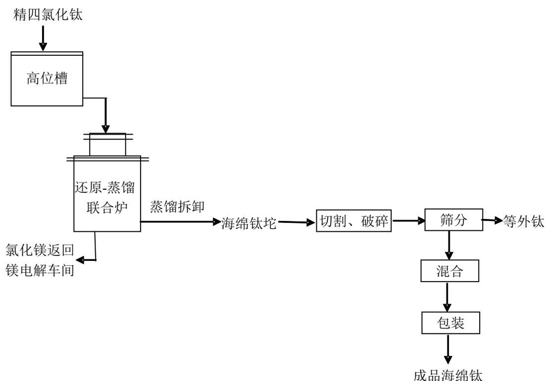
图 2-3 还原-蒸馏车间生产工艺及排污节点图
